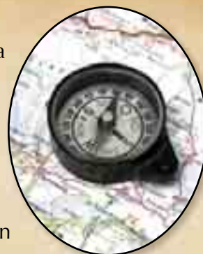
Figura 6.2. La brújula tiene una aguja que se orienta hacia el Norte geográfico.
